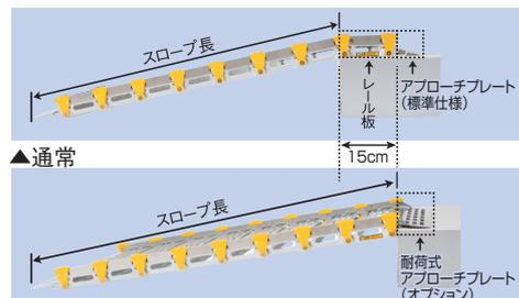
標準仕様のアプローチプレート(両端の2枚)のうち上階側を耐荷式アプローチプレートに交換すると、約15cmスロープ長を長くして使用できます。
