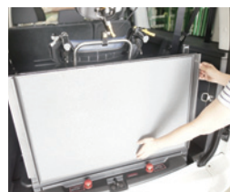
7 搭乗を終えスロープをたたみます。リアゲートのサイレンサーの効果で走行中のスロープのガタツキ音は発生しません。
