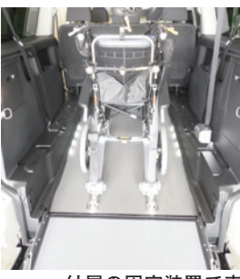
6 付属の固定装置で車いすを固定した後、搭乗者をシートベルトで安定させます。
