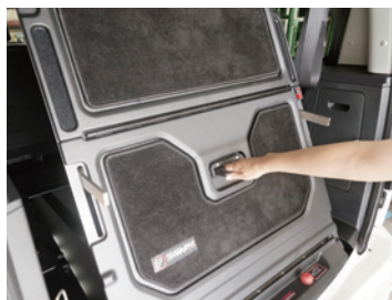
2 スロープの床板を車内側に倒します。
