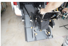
5 ベルトを掛け車いすを押し上げます。逆回転防止機能付の巻取りベルトなので手を離しても車いすは下がりません。
