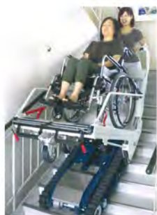
車いすに乗ったままで階段を昇降 階段昇降車
