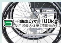
フレームの剛性を落とさずに部品を見直すことで軽量化を実現。段差乗り越え・旋回時もスムーズに操作ができます。
